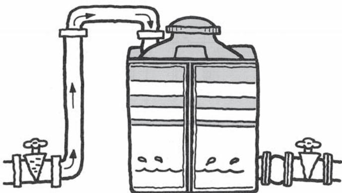
水張りテストに使用した水は完全に除去し、拭き取った後使用して下さい。薬品によっては(特に硫酸などは)、残っている水と反応して発熱を起こし、タンクが変形、あるいは溶けて穴があくなどの大事故につながる可能性があります。
